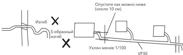
3. Установите соединительный трубопровод на нужную позицию, закрутите гайки рукой, затем затяните их с помощью гаечного ключа.
